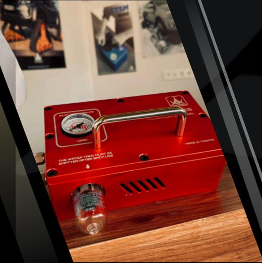
Elektronik kontrol paneli sayesinde kompresörle pozitif-negatif basınç dönüşümünü sağlayarak çalışır. Bu sistem, mevcut kompresör cihazınıza bağlanarak vakum kuvveti oluşturur ve ek bir vakum pompasına ihtiyaç duymadan verimli bir çözüm sunar. Ayrıca, yenilikçi tasarımı sayesinde hava tüketimini %90 oranında azaltarak enerji verimliliği sağlar ve operasyon maliyetlerini düşürür.
